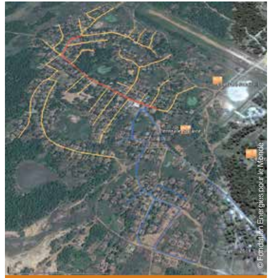
Exemple de traçage de réseau.
