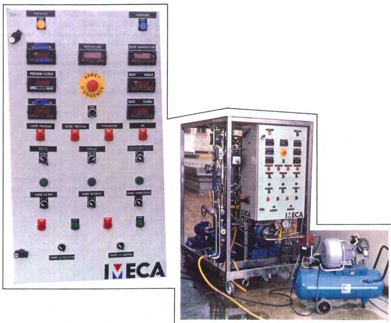
Figure 8 - Pilote de microfiltration tangentielle a : tableau de commande b : vue générale
