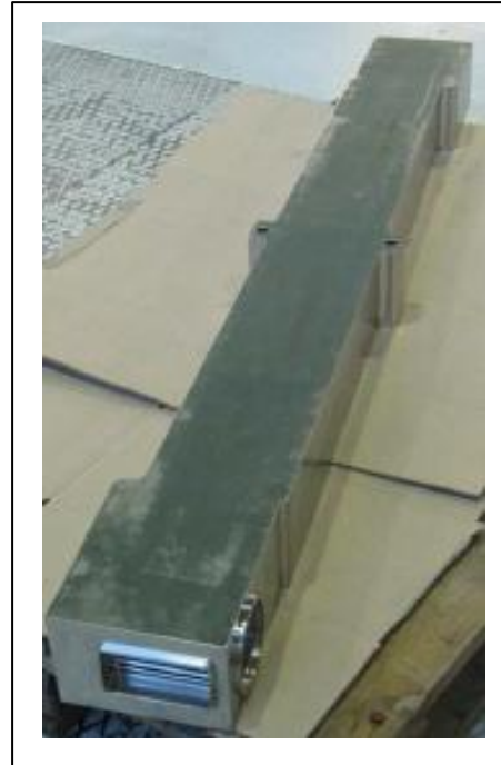
Figure 3- 14 : maquette 40kW d'un échangeur sodium gaz pour l'essai dans la boucle d'essais en sodium DIADEMO
