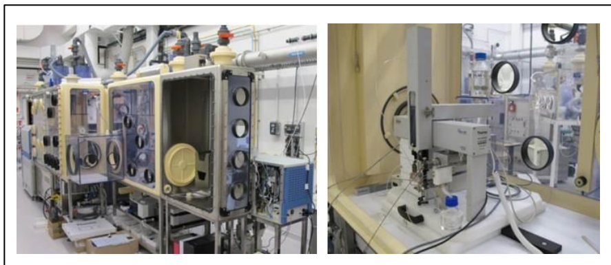
Figure 2-46 : Vues de l'équipement nucléarisé pour le couplage simultané d'une séparation chromatographique à l'ICP MS et l'ESI MS
