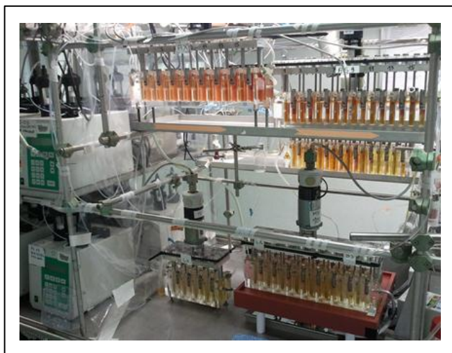
Figure 2- 40 : Vue de l'ensemble des batteries de mélangeurs-décanteurs utilisés pour les essais et schéma mis en œuvre pour les essais
