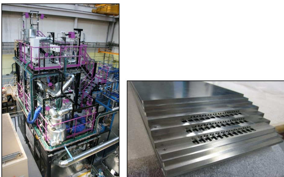
Figure 3- 65 : circuit Diademo-Na et illustration d'une maquette d'ECSG
