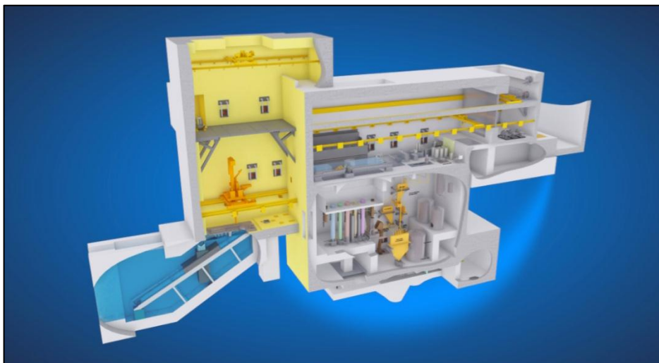
Figure 2- 13 : Représentation schématique du nouvel atelier de tête de procédé TCP en projet à l'usine de La Hague [reproduit avec l'autorisation de l'ingénierie E&P d'AREVA]
