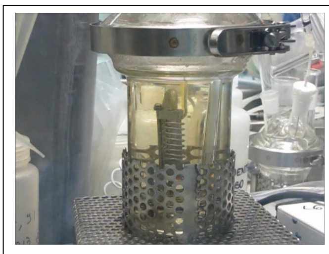
Figure 2- 14 : Photographie du réacteur dédié à l'acquisition des cinétiques de dissolution de MOX REL non irradié en boîte-à-gants dans l'installation Atalante du CEA Marcoule (cas illustré de pastilles gainées placées en position verticale).
