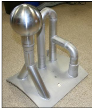
Figure 3- 19 : maquette pour essais de visualisation sous sodium et reconstruction d'images CIVA (© Indira Gandhi Centre for Atomic Research)
