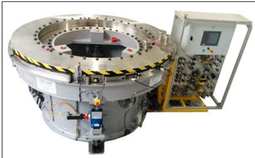
Figure 3- 20 : maquette pour études de qualification de systèmes d'étanchéité pour le bouchon tournant
