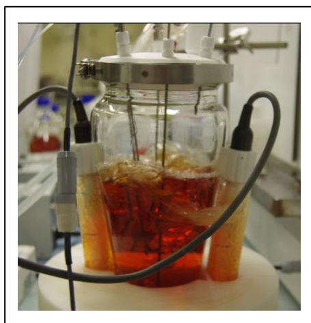
Figure 2- 43 : Vue du concentrateur lors d'essais sur solutions simulées
