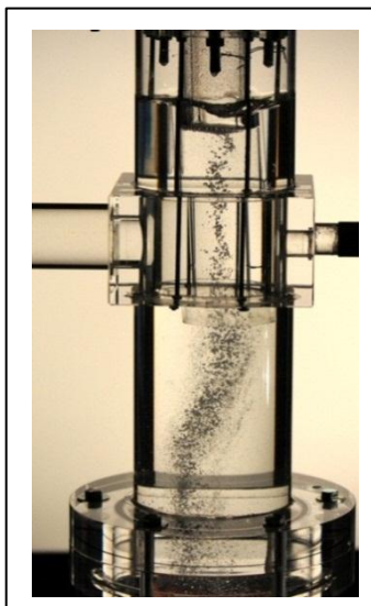
Figure 2- 79 : Maquette du séparateur liquide/gaz en cours de fonctionnement
