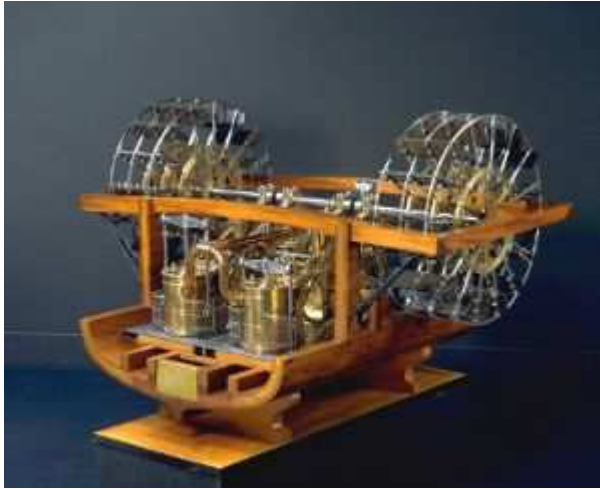
Maquette de machine à vapeur de la corvette à roues le Sphinx , MnM 17CN 3 © Musée national de la Marine
