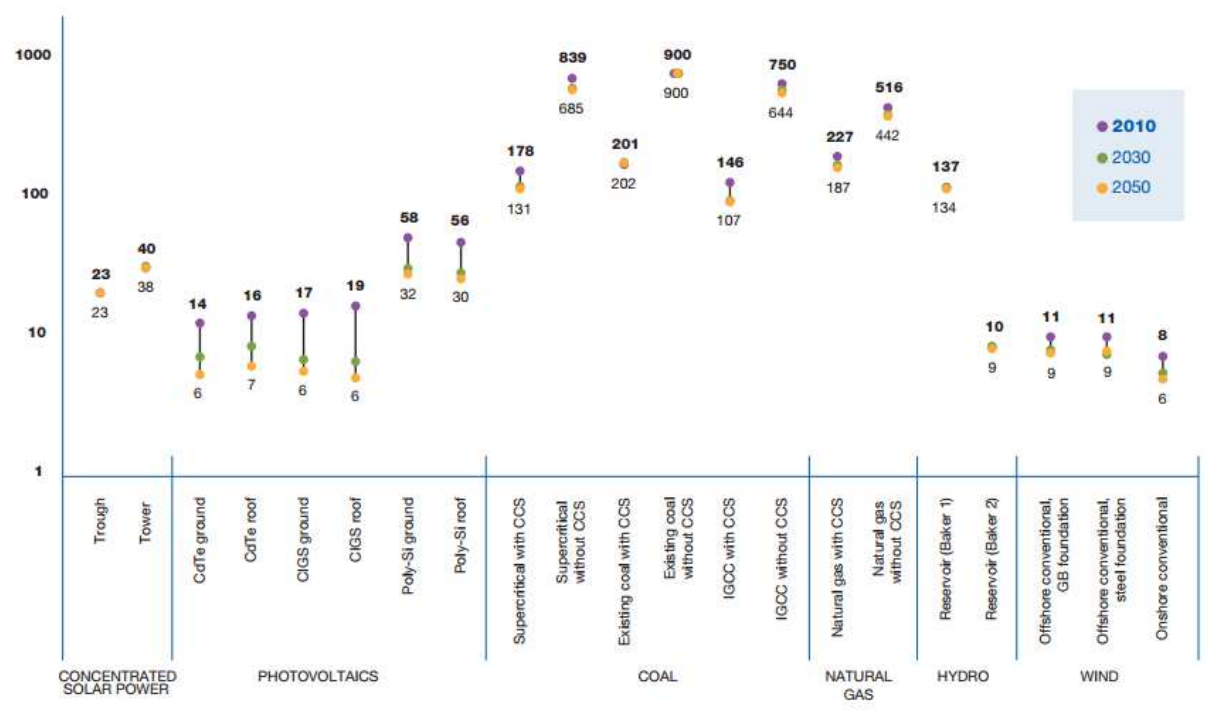
Figure 11 : émissions en ACV de différentes technologies EnR et conventionnelles en g CO 2 e / kWh
