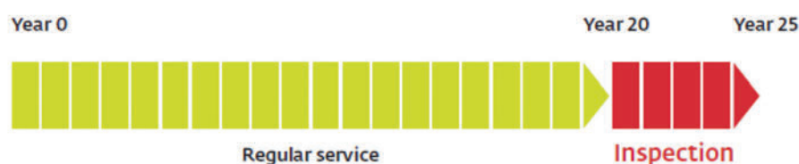
FIGURE 67 : ENTRETIEN DES ÉOLIENNES DURANT LEUR DURÉE DE VIE INITIALE ET APRÈS EXTENSION
