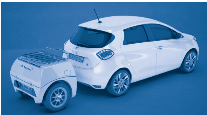
Figure 37 – Prolongateur d'autonomie amovible proposé par l'entreprise EP Tender
