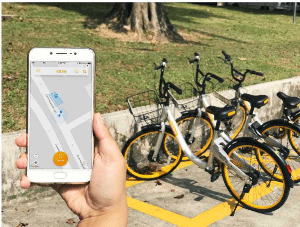
Figure 26 : Utilisation de la technologie du geofencing pour le stationnement par l'opérateur oBike à Singapour (source : oBike)
