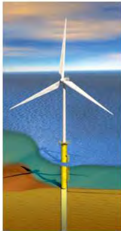
Figure 1 : Structure monopieu Mer du Nord
