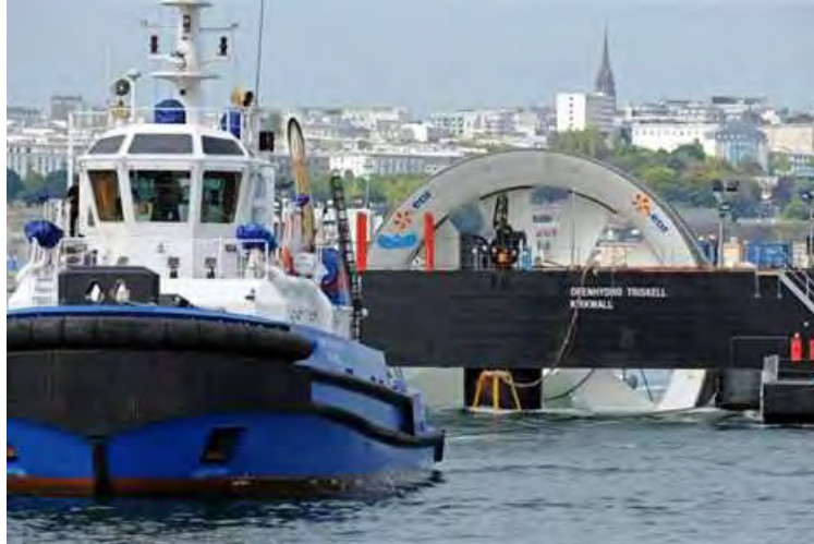
Figure 7 : Hydrolienne OpenHydro en test dans la rade de Brest
