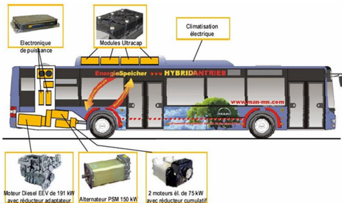
Figure 40 : Composants d'un autobus hybride © AVEM
