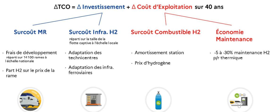
Figure 7 – Schéma explicatif sur le calcul du surcoût total de possession du train hydrogène
